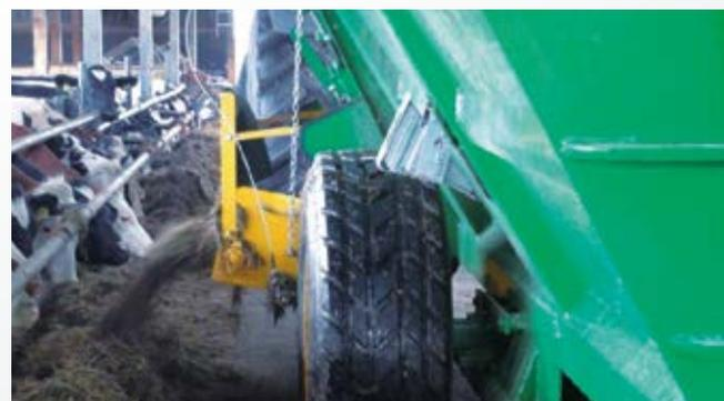
Der Futteraustrag erfolgt über kettengetriebene Fördertröge, wobei der steuerbare Dosierschieber die Austragsmenge präzise reguliert - je nach Bedarf. Die Bedienung erfolgt seriell über sehr stabile Bowdenzüge oder optional mit elektrischer Fernbedienung.
