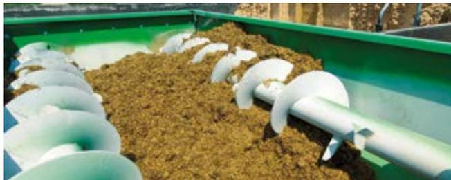
Die RX-Serie umfasst Mischwannen-Kapazitäten von 12 bis 30 Kubikmeter, ein reichhaltiges Programm an Sonderausstattungen - von Mischwannen aus Teiledelstahl, über Edelstahl verstärkte Rührflügel und massiv Edelstahl-Windungen, bis zum Kraftfutter-Einfülltrichter, ist alles auf Wunsch erhältlich.
