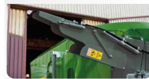
Hydraulisch gesteuerte Auswurfklappe
